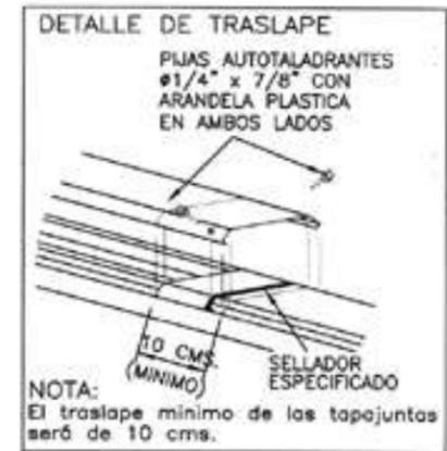
Para fijación de la tapajunta se deberá colocar 2 pijas al frente y después 1 pija a cada 1.50 mts., alternadas, repartidas a lo largo de la misma.
